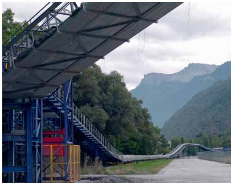
Die Förderbänder mit dem Ausbruchmaterial erstrecken sich über 6,5 km.
