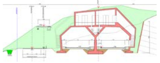
2 Technisches Lokal auf dem Dach des gedeckten Einschnitts Pfyng
