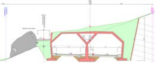
1 Querschnitt des gedeckten Einschnitts Pfyng im Bereich des Mördersteins
