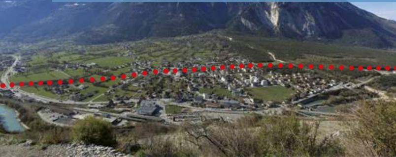
Aufgelegt im August 2017, verläuft das Projekt der Autobahn A9 durch den Pfywald zu 75 % unterirdisch. Der 2'080 m lange Tunnel Susten ist ein Schlüsselprojekt. Seine Überdeckung beträgt maximal 30 m – die Kirche von Susten liegt sogar nur 22 m über der Tunneldecke.
