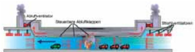
Lüftung im Ereignisfall.
