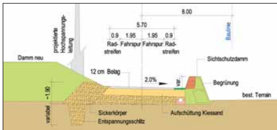
Normalprofil mit Sichtschutzdamm südlich von Lalden.
