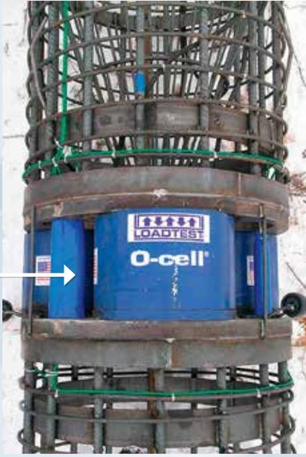
Die Bodenqualität bestimmt über die Tragfähigkeit des Untergrundes. Dies ist insbesondere für Bauwerke wichtig, welche auf Pfählen stehen. Ein Fachinstitut prüft nun den Boden für die neu zu bauende Autobahnbrücke im Turtig, die zu verstärkende Brücke Turtig – Niedergesteln und die Kunstbauten im Lufu. Dabei kommt ein relativ neues Verfahren zum Einsatz.
