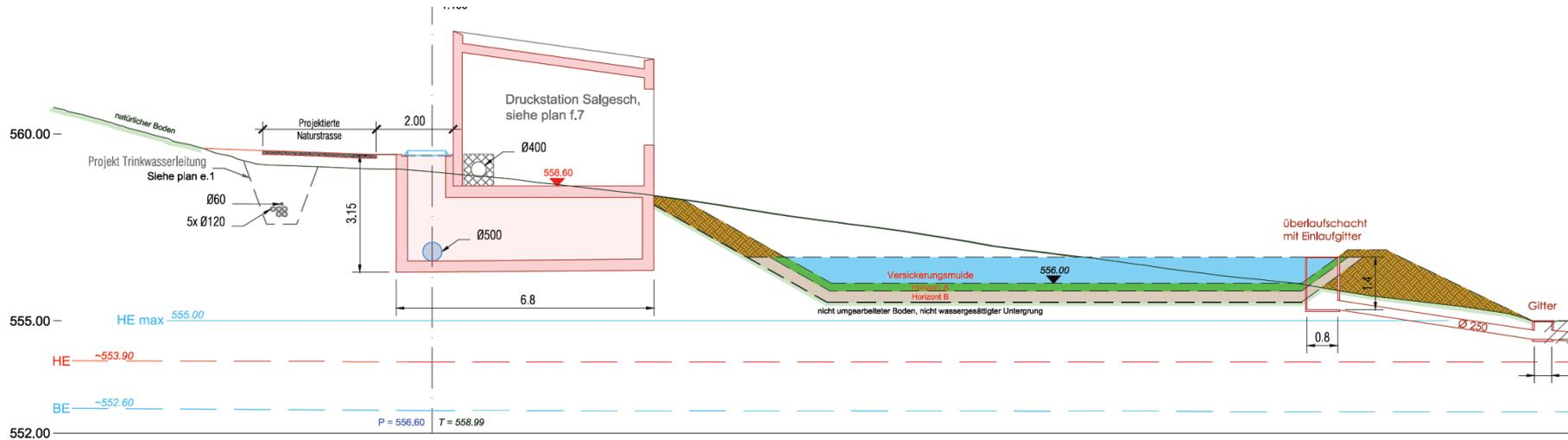
Querschnitt der Zwischenstation, des Abscheiders und des Versickerungsbeckens
