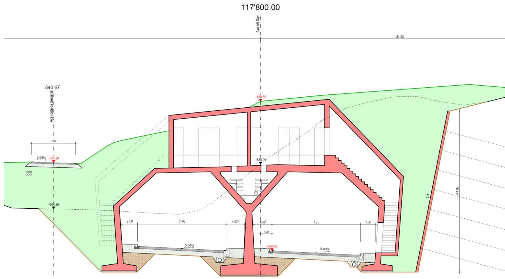
*Coupe type de la TC Finges avec le local technique sur la partie supérieure*
