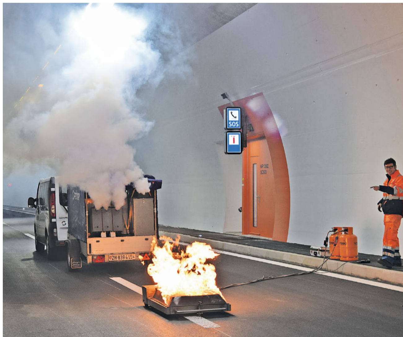
Simulation. Im Turtmänner Tunnel wird vor der Inbetriebnahme das «schlimmstmögliche Szenario» getestet. Innerhalb von drei bis vier Minuten war der Tunnel wieder rauchfrei.
