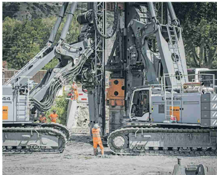
Riesentrauper. Die Maschinen erzeugen einen Druck von bis zu 170 Tonnen.
